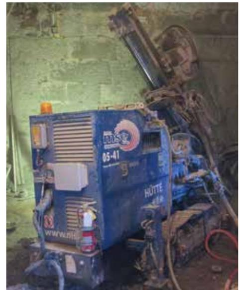
Le HBR 202 E de Hütte peut herscher en passant par des entrées de porte de moins d'un mètre de largeur et réussir à se faufiler dans des espaces restreints comme dans ce coin. Les espaces clos ne présentent aucun problème de ventilation étant donné que l'engin de forage ne consomme pas d'oxygène et n'émet pas de gaz d'échappement.
