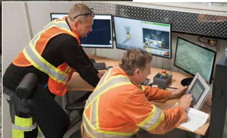
**Steve Germain**, à gauche, transfère la commande à distance de la ST14 à **Wayne Locht**, qui revient tout juste à la surface après avoir conduit l'engin de forage jusqu'à la zone d'automatisation et s'être assuré que personne ne se trouve à ce niveau de la mine.
