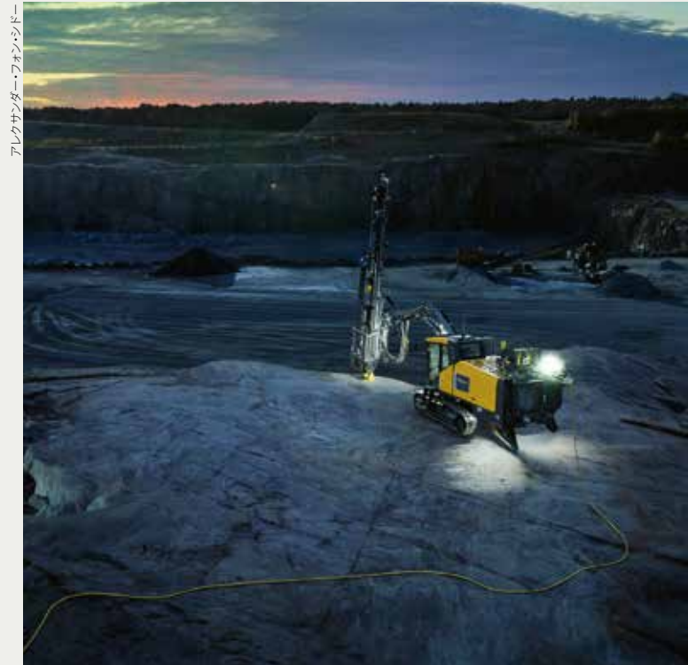
アレクサンダー・フォーン・ストー ストックホルムでスキャンスカ社がSmartROC T35 Eのテストを進めています。世界各地の露天掘り鉱山や採石場での掘削を排ガスゼロへと転換する上で、この掘削機が大きな意味を持ちます。
