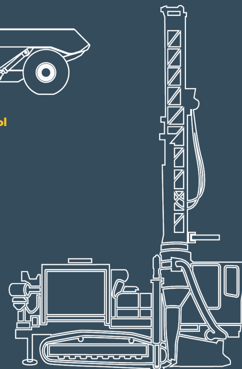
Роторные установки для бурения взрывных скважин
