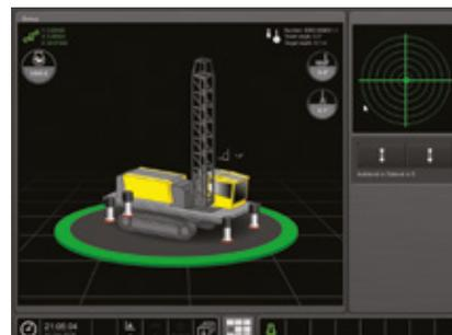
**Подготовка к работе и передвижение:** отображение параметров машины во время подготовки к работе и во время передвижения.
