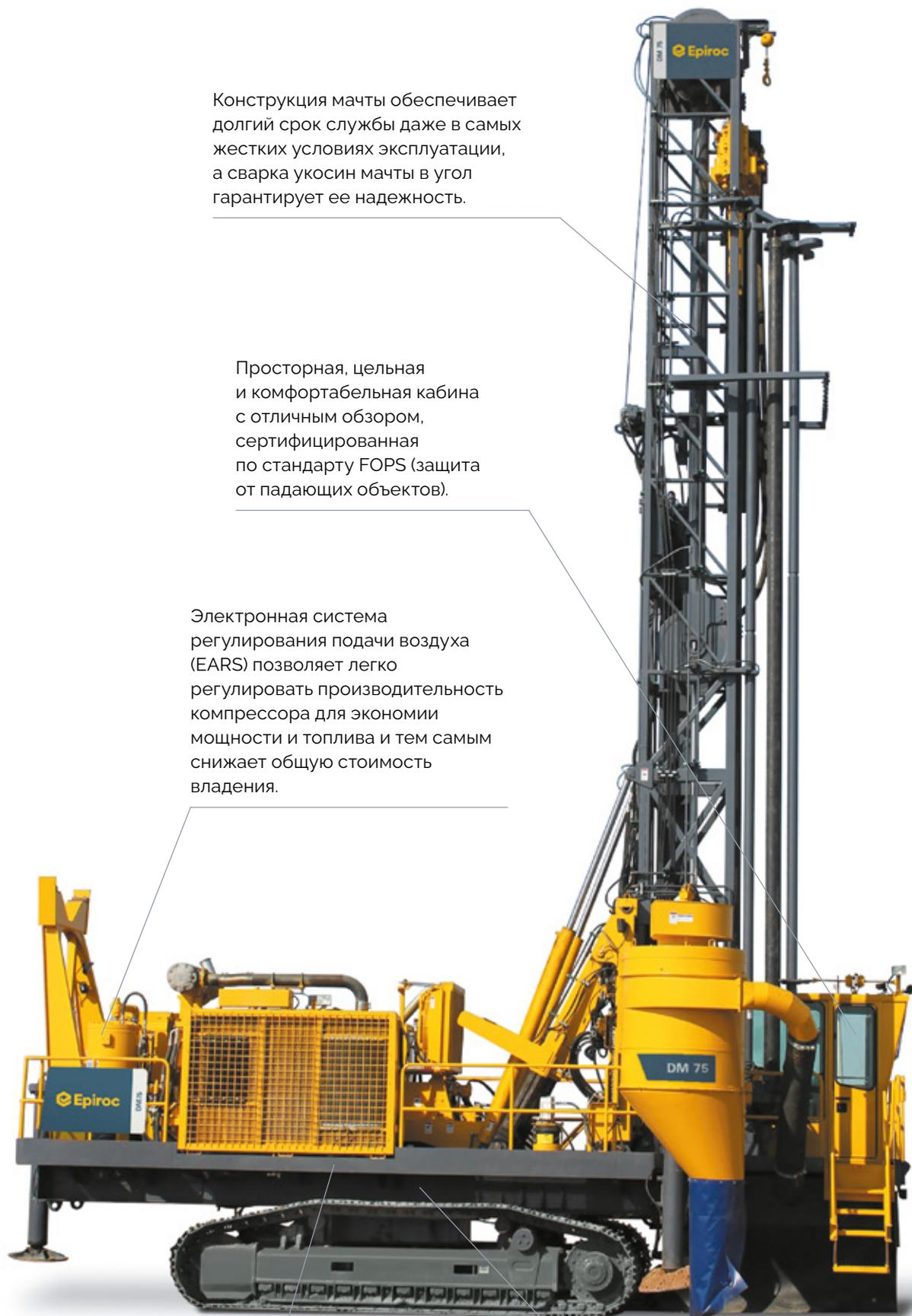
Конструкция мачты обеспечивает долгий срок службы даже в самых жестких условиях эксплуатации, а сварка укосин мачты в угол гарантирует ее надежность.
