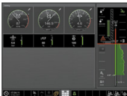
Бурение: показывает информацию о давлении и расходе различных систем в процессе бурения.
