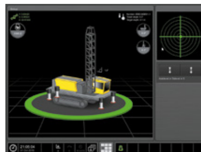
Настройка и ход: показывает состояние машины во время установки и во время движения.
