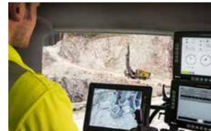
La station de pilotage à distance BenchREMOTE, en option, permet à une personne de diriger, de manière sécurisée et simultanée, jusqu'à trois machines de forage SmartROC depuis une distance (horizontale) de 100 mètres. La productivité de l'opérateur en est ainsi grandement améliorée et la sécurité atteint un tout autre niveau.
