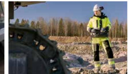
Le boîtier de télécommande, en option, permet à l'opérateur de quitter la cabine pour piloter le SmartROC D50 depuis une distance sécurisée en cas de besoin. L'écran intégré affiche toutes les informations de base nécessaires au pilotage de la machine de forage.
