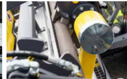
Les engins de forage de la gamme SmartROC ont un système automatique de manipulation des tiges qui est à la fois rapide et efficace. Le système repose sur des capteurs intégrés et une chaîne robuste permettant une vitesse de progression rapide et constante.
