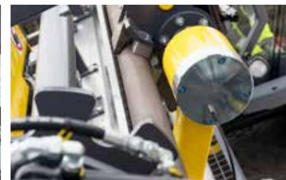
SmartROC 钻机的特点是快速且高效的自动钻杆处理系统。该系统包括集成传感器和一个重型链，提供了一个快速、统一的推进速度。
