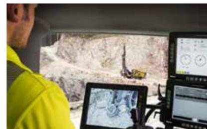
BenchREMOTE 选项可以由一个人在水平距离 100 m 内安全地控制 3 台智能钻机。这大大提高操作员的生产效率，并将安全性提升到了一个全新的水平。
