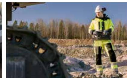
可选的无线遥控功能使得操作员走出驾驶室，必要时可在安全距离控制 SmartROC D50。集成显示器显示运行平台所需的所有基本信息。
