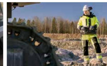
Le boîtier de télécommande, en option, permet à l'opérateur de quitter la cabine pour piloter le SmartROC D55 depuis une distance sécurisée en cas de besoin. L'écran intégré affiche toutes les informations de base nécessaires au pilotage de la machine de forage.
