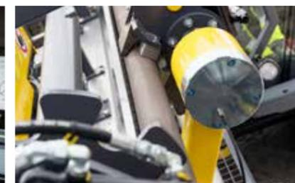
Les engins de forage de la gamme SmartROC ont un système automatique de manipulation des tiges qui est à la fois rapide et efficace. Le système repose sur des capteurs intégrés et une chaîne robuste permettant une vitesse de progression rapide et constante.
