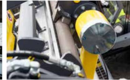
SmartROC-Bohrwagen verfügen über ein schnelles und effizientes automatisches Bohrstangenmagazinsystem. Das System schließt integrierte Geber und eine hochbelastbare Kette ein, die für eine schnelle, gleichmäßige Lafetengeschwindigkeit sorgt.
