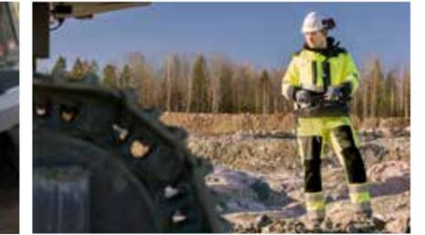
Die optionale Funkfernsteuerung (Radio Remote Control) ermöglicht es dem Bediener, aus der Kabine herauszutreten und den SmartROC D55 bei Bedarf aus sicherer Entfernung zu steuern. Der integrierte Bildschirm zeigt alle grundlegenden Informationen an, die für den Betrieb des Bohrwagens erforderlich sind.
