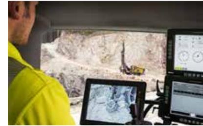
Die Option BenchREMOTE ermöglicht es einer Person, bis zu drei SmartROC-Bohrwagen gleichzeitig aus einer horizontalen Entfernung von 100 Metern sicher zu steuern. Dies erhöht die Produktivität des Bedieners drastisch und befördert die Sicherheit auf ein ganz neues Niveau.
