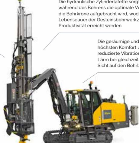
Die doppelte Schlauchtrommel mit einer Führung für jeden Schlauch erhöht die Lebensdauer der Schläuche und erfordert keine Schmierung.
