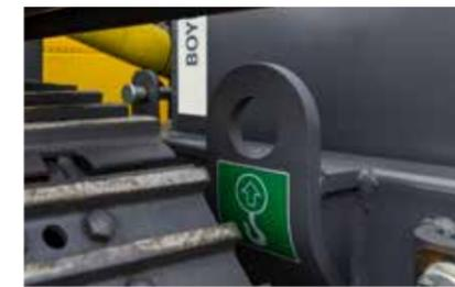
Буровая установка состоит из семи основных модулей, самый тяжелый из которых весит 1000 кг (2200 фунтов). Каждый модуль оборудован точками подъема для безопасной и удобной транспортировки вертолетом.
