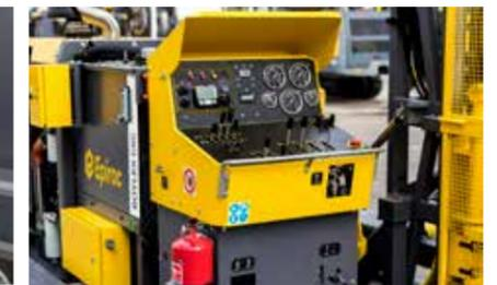
Все функции бурения выполняются с помощью эргономичной и удобной панели управления, на которой также отображаются все параметры бурения, необходимые для обеспечения высокопроизводительного процесса.
