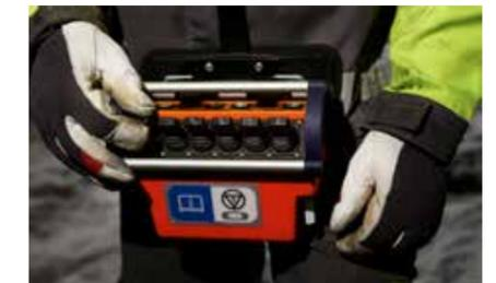
Установки Boyles C5C на гусеничном ходу имеют дистанционное радиуправление, которое позволяет управлять ими с безопасного расстояния.
