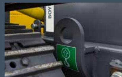
钻机可被快速拆解为七大模块，最大模块重量为 1 000 kg (2 200 lb)。每个模块均设计有起吊点，确保安全、高效的直升机搬运。
