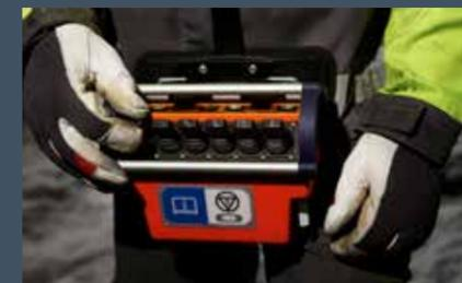
履带式 Boyles C5C 配备无线遥控装置，您可以站在一定距离外移动钻机，工作环境的安全性得到大幅提高。
