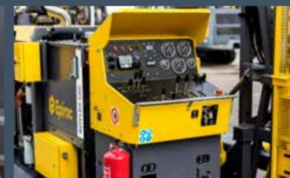
拥有人机工程学和用户友好设计理念的控制面板，可以显示所有必要的工作参数，以确保高效钻进。
