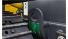
A perfuratriz pode ser dividida em sete módulos principais, sendo 1.000 kg (2.200 lbs) o mais pesado. Cada módulo é equipado com pontos de içamento, para garantir um transporte por helicóptero seguro e eficaz.
