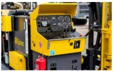
Todas as funções de perfuração são realizadas através de um painel de controle ergonômico e fácil de usar, que também exibe todos os parâmetros de perfuração necessários para garantir a produtividade.
