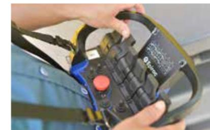
Los equipos perforadores con transportador de oruga Boyles C6C incluyen un sistema Radio Remote Control, que le permite desplazar el equipo perforador a distancia, proporcionando así un entorno de trabajo más seguro.
