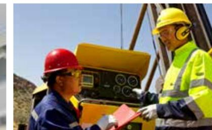
Diseño ergonómico y fácil de usar, que muestra los parámetros de perforación necesarios para garantizar una perforación productiva. También se incluye una función de retención para prolongar la vida útil de la broca.
