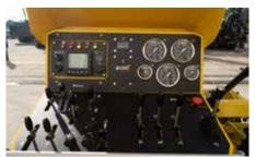
拥有人机工程学和用户友好设计理念的控制面板,不仅能够显示所有必要钻进参数,而且可以完成所有钻进控制,从而确保高效钻进。Boyles C6/C6C 还具有提钻钻进功能,能够有效延长钻头寿命。
