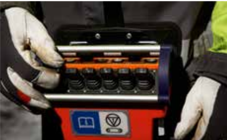
履带式Boyles C8C配备无线遥控装置，您可以站在一定距离外移动钻机。
