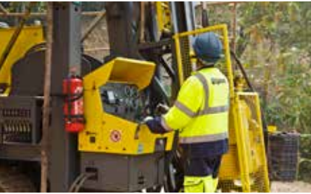
拥有人机工程学和用户友好设计理念的控制面板，可以显示所有必要钻进参数，以确保高效钻进。还具有提钻钻进功能，有效延长钻头寿命。
