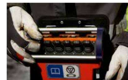
As plataformas de perfuração com esteiras C8C vêm com um controle remoto por rádio, que permite operar plataforma à distância.
