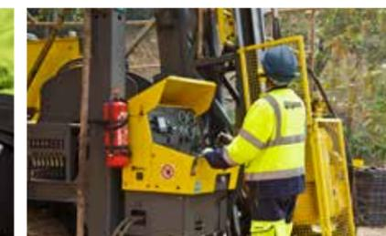
Design ergonômico e fácil de usar, que exibe os parâmetros de perfuração necessários para garantir uma perfuração produtiva. Também está incluída uma função de retenção para prolongar a vida útil da broca.
