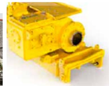
La tête de rotation B-H est de série sur cette foreuse et la tête de rotation P est offerte en option. Il s'agit de têtes de rotation bien connues et éprouvées qui offrent une grande fiabilité et un niveau de couple impressionnant. La taille P permet également aux carottiers de passer à travers la tête.
