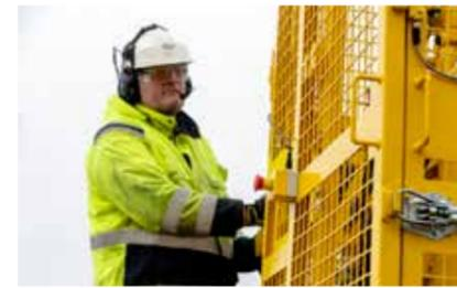
La foreuse est entièrement conforme à la norme d'ingénierie européenne EN 16228. Des verrouillages sont présents sur des éléments importants, tels que la protection et la tête de rotation. Les fonctions de sécurité de cette foreuse ont été conçues pour améliorer la sécurité de l'opérateur sans nuire à la productivité.
