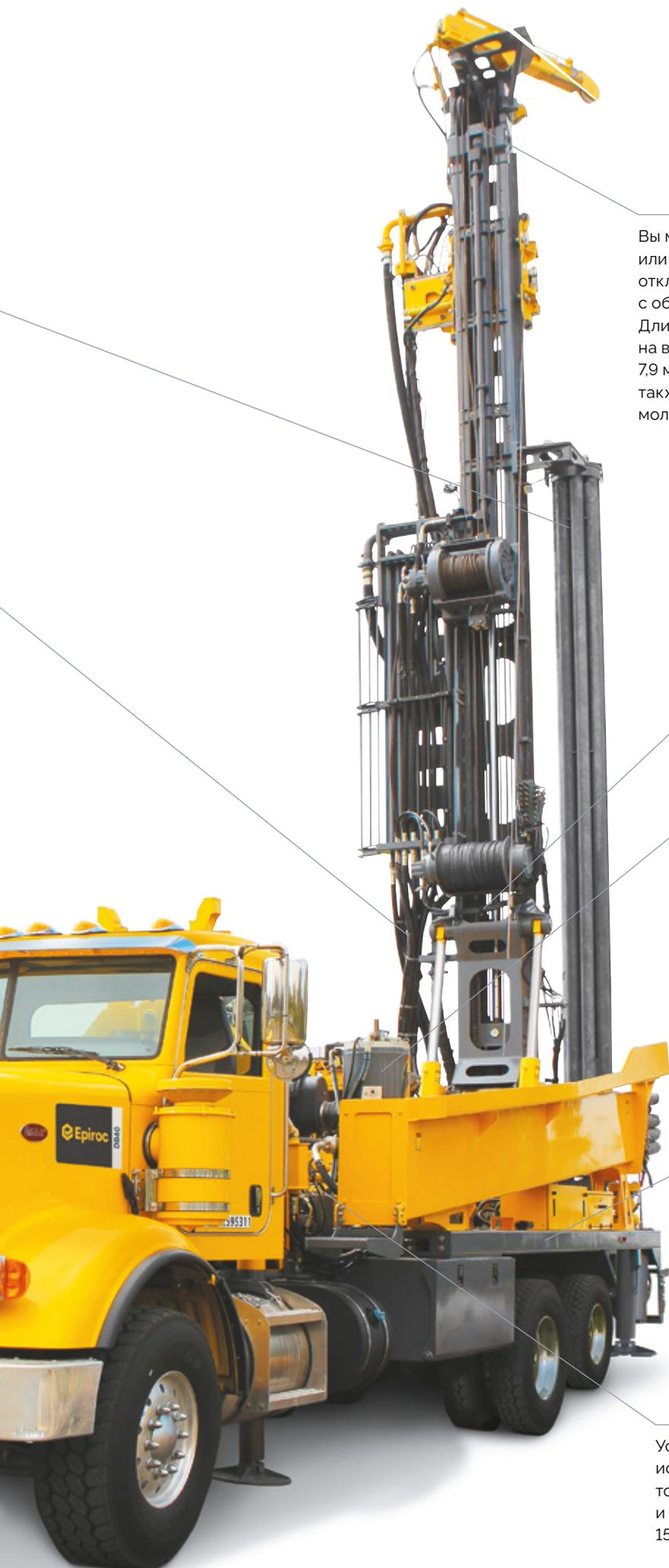
Вы можете выбрать мачту для бурения на воду или многофункциональную мачту (МР), способную отклоняться и опускаться до уровня земли при бурении с обратной циркуляцией или колонковом бурении. Длина мачты МР составляет 11,7 м, а мачта для бурения на воду имеет два варианта: 10,5 м (ход вращателя — 7,9 м) или 11,7 м (ход вращателя — 9,1 м). В последних также предусматривается возможность установки молота для обсадной колонны под вращателем.
